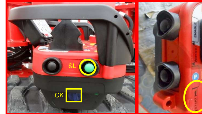
Afbeelding 7: contactsleutel en knop koppeling afstandsbediening.
