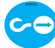
Afbeelding 62: aanduiding koppeling onderstel voor vervoer hoogwerker.
