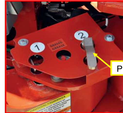
Afbeelding 18: instelling handelingen op stempelpoten.
