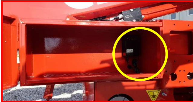
Afbeelding 10: opladen batterij afstandsbediening.
